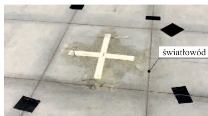
Fot. 2. Rozeta tensometryczna oraz czujniki światłowodowe przed aplikacją kleju Photo 2. Tensometric rosette and fibre optic sensors before glue application [Fot. F. Grzymalski]
