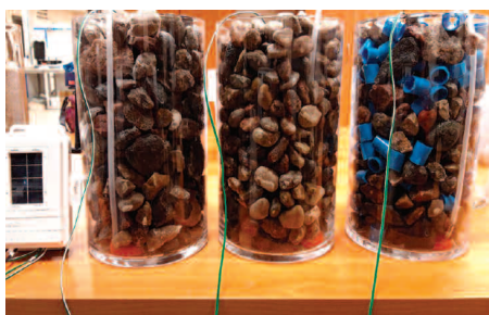
Fot. 3. Badania odsączalności i potencjału wilgoci różnych złoży filtracyjnych Photo 3. Research on the drainage and moisture potential of various filter beds
