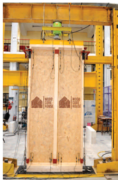
Fot. 1. Badany panel ścienny Photo 1. Tested wall panel
