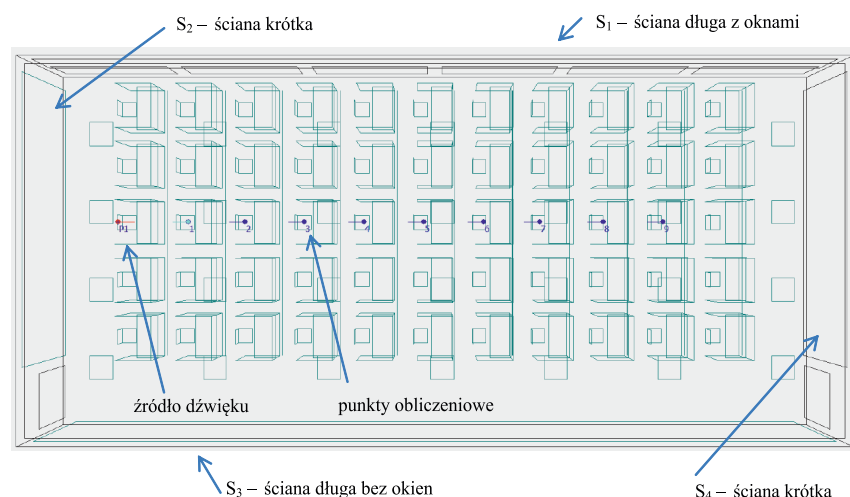
Rys. 1. Rzut rozpatrywanego pomieszczenia (wygenerowany w programie ODEON) z zastosowaniem ekranów stanowiskowych (rysunek 2)
