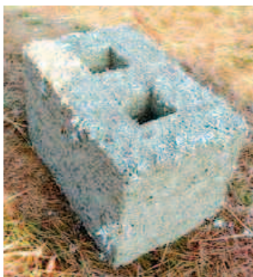
Fot. 2. Prefabrykowany bloczek hempcrete [6]
