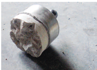
Fot. 2. Badanie wytrzymałości na rozciąganie podkładu betonowego metodą pull-off Photo 2. Pull-off test of the floor screed
