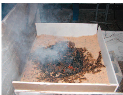
Fot. 2. Badanie trocin. 10' badania. Brak spalania trocin (żarzenie od źródła ognia) Photo 2. Sawdust testing. 10' of test. No sawdust burning (glowing from the fire source)
