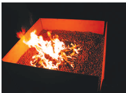
Fot. 1. Badanie granulatu. 30' badania. Widoczne rozprzestrzenienie płomieni po powierzchni
