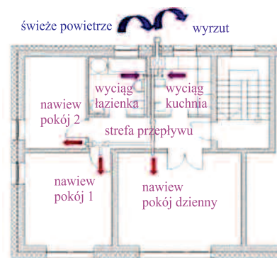
Rys. 5. Schemat rozprowadzenia świeżego powietrza i odprowadzenia zużytego [3]
