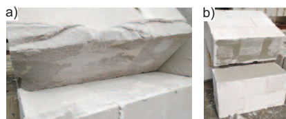
Fot. 3. Zniszczenie próbek na zaprawie: a) z piany poliuretanowej; b) cementowo-polimerowej podczas badania wytrzymałości na rozciąganie przy zginaniu Photo. 3. Destruction of samples made on: a) polyurethane mortar; b) cement-polymer mortar; after tensile strength during bending test
