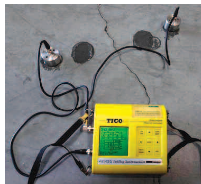
Fot. 4. Badania zasięgu (głębokości) rysy metodą ultradźwiękową
