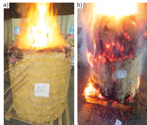
Fot. 4. Dwudziesta (a) i czterdziesta druga (b) minuta badania balotu ze słomy Photo 4. Twenty (a) and forty-second (b) minute of straw bale test
