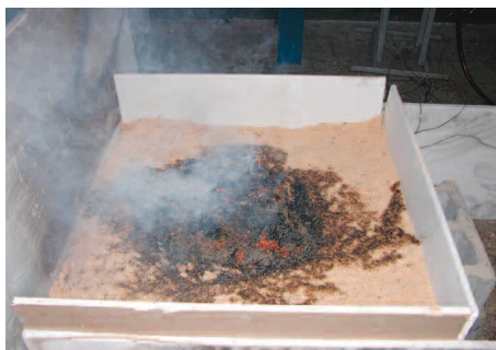
Fot. 2. Dziesiąta minuta badania trocin. Brak spalania (żarzenie od źródła ognia) Photo 2. Tenth minute of sawdust testing. No sawdust burning (glow from the source fire)
