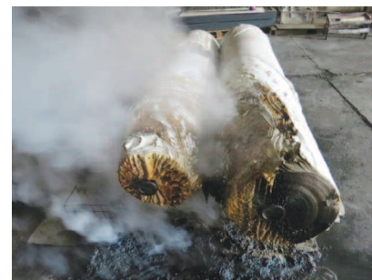
Fot. 7. Badanie bel filcu z drugim położeniem źródła ognia – widok po ugaszeniu próbki Photo 7. Study of the felt bale with the second location of the fire source - view after extinguishing the sample
