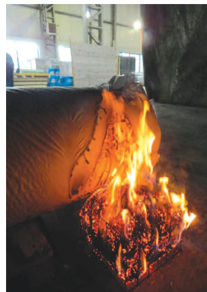
Fot. 6. Badanie bel filcu w przypadku drugiego położenia źródła ognia Photo 6. Study of felt bands in case the second location of the fire source
