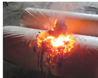
Fot. 5. Dziewiąta minuta badania – pali się tylko filc z poliestru (PES) – koszyk ze spaloną wełną drzewną usunięty Photo 5. Nine minute of testing – it's burning only polyester felt (PES) – basket with burnt wood wool removed
