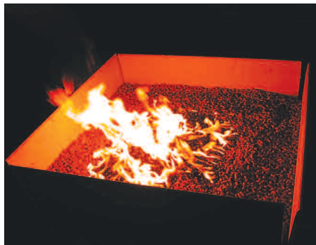
Fot. 1. Trzydziesta minuta badania granulatu. Widoczne rozprzestrzenianie płomieni po powierzchni Photo 1. Thirty minute of granulate test. Visible spread of flames on top
