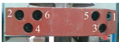
Fot. 4. Kolejność dokręcania śrub [8] Photo 4. Order of bolt tightening [8]
