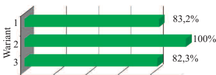
Rys. 2. Relacje nakładów początkowych (obejmujących koszt dostawy i montażu) barierek stalowych zabezpieczonych antykorozyjnie wg trzech systemów
