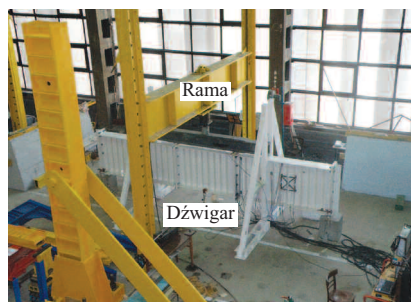
Fot. 1. Dźwigar M 2.21 (WTA 1000/300x15) z żebrem usztywnionym na stanowisku badawczym
