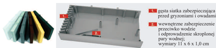
Fot. 2. Puszki wentylacyjno-odwadniająca do ścian trójwarstwowych z elewacją klinkierową [2]
