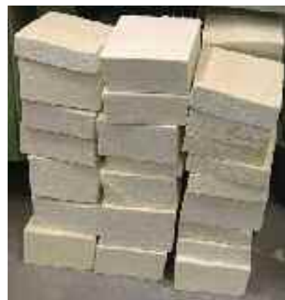
Fot. 1. Pocięte próbki PUR o grubości 7 – 16 cm
