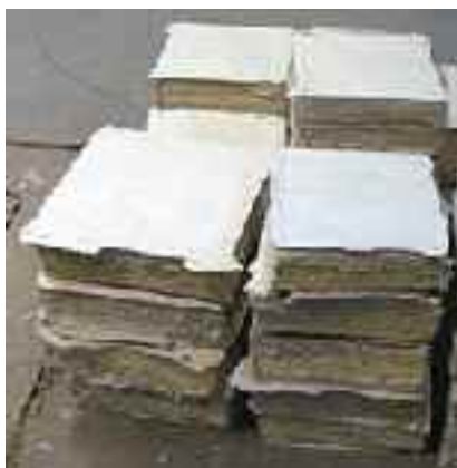
Fot. 2. Próbkę przygotowane do badań, wyrównane warstwą gipsu budowlanego Photo 2. Samples prepared for testing, leveled with a layer of construction gypsum
