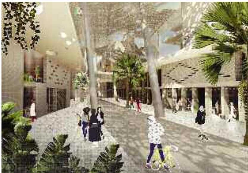
Rys. 2. Osłony przeciwsloneczne ciągów pieszych wykonane z przeziernych ogniw fotowoltaicznych
